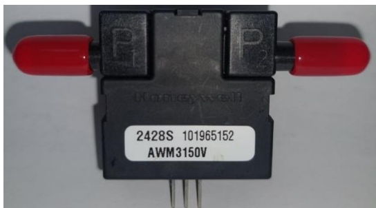
Figura 5. Sensor de flujo de biogás Honeywell® AWM 3150 V
