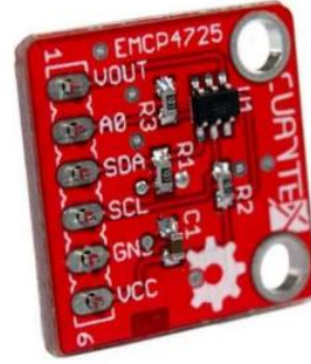
Figura 8. Módulo DAC EMPC4725 de la empresa CUANTEX ® (Fuente: hetpro-store.com)
