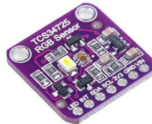
Figura 4. Módulo convertidor de tono de luz digital con filtro IR, TCS34725 [5].
