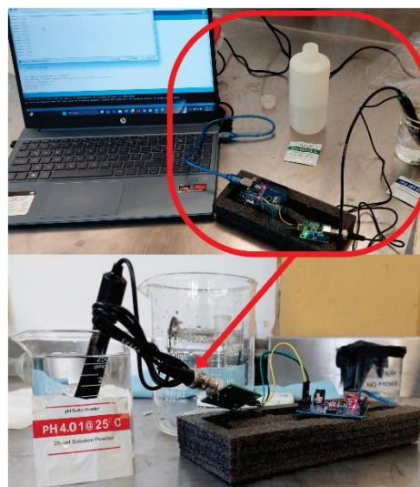
Figura 9. Interfaz de adquisición de datos conectada al sensor de pH
