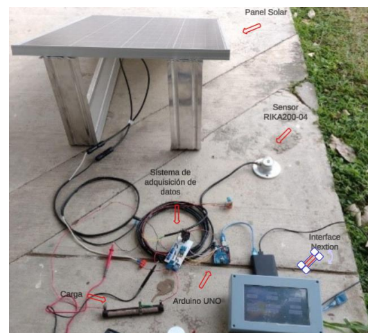
Figura 14. Conexión de sensores y panel al Arduino.
